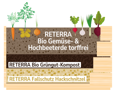
Schematischer Aufbau eines Hochbeets mit RETERRA Fallschutz, Bio Grüngutkompost und Bio Gemüse- & Hochbeeterde torffrei
